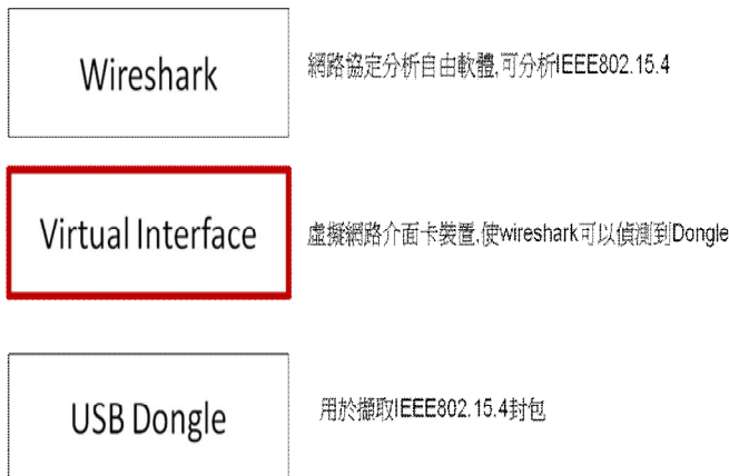
圖四：Wireshark 為軟體，USB Dongle 為硬體的網路封包分析架構
